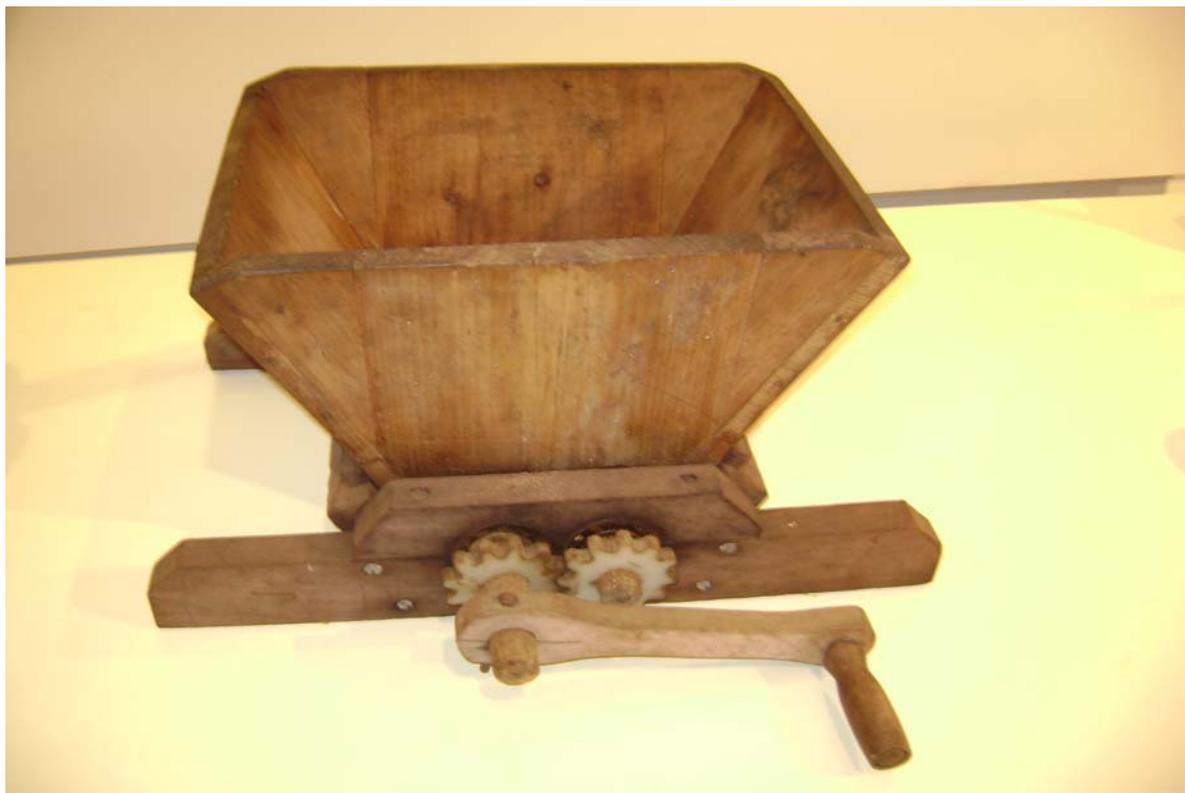
**FIGURA 07 - Máquina artesanal utilizada para esmagar uva para produzir vinho**
